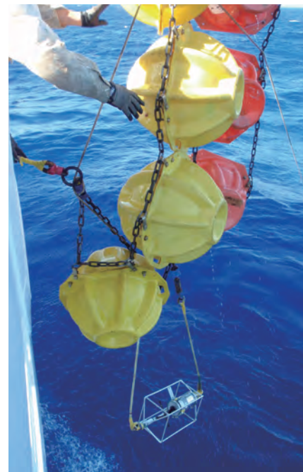
写真2. 三次元超音波流速計(三次元超音波流向流速計に錘とフイをつけて係留し、海中の流れを1年間にわたって連続観測する。こういう気長な観測も行っている。)
